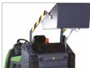
SISTEMA HIDRÁULICO DE DESCARGA DEL DEPÓSITO
