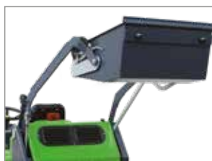
SISTEMA HIDRÁULICO DE DESCARGA DEL DEPÓSITO
