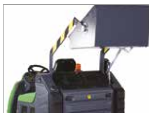
SISTEMA HIDRÁULICO DE DESCARGA DEL DEPÓSITO
