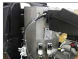
CALDERA 3 ETAPAS DE ALTA EFICIENCIA DE ACERO INOXIDABLE AISI 316
