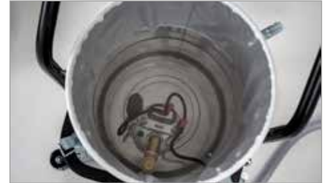
Filtro de nylon adicional para la limpieza del aceite
