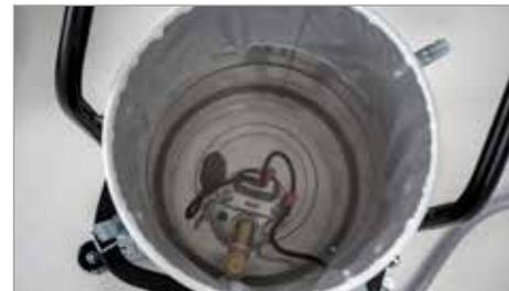
Filtro secondario in nylon per una migliore filtrazione dell'olio
