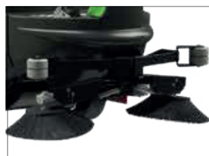
SISTEMA DE PRE - BARRIDO
