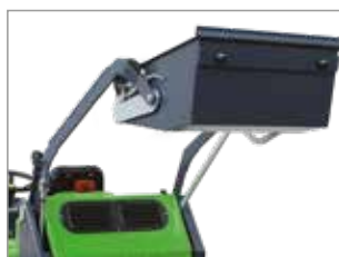
SYSTÈME DE DÉCHARGE HYDRAULIQUE DU BAC À DÉCHETS
